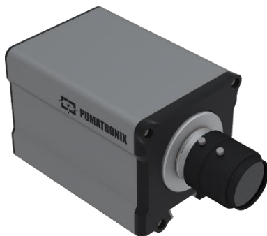
Figura 3 - Linha ITSCAM 600 FHD com lentes CS Mount
