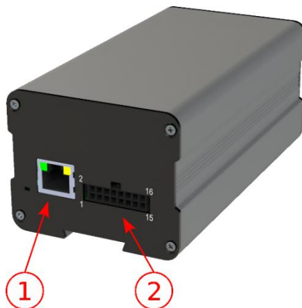
Figura 9 – Interfaces disponíveis no dispositivo: 1) Ethernet; 2) Microfit 16 vias (conector alimentação, IOs, RS-232)
