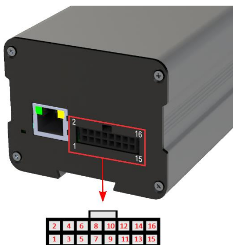
Figura 11 - Terminais do Conector de alimentação e sinais (Microfit) da ITSCAM 400
