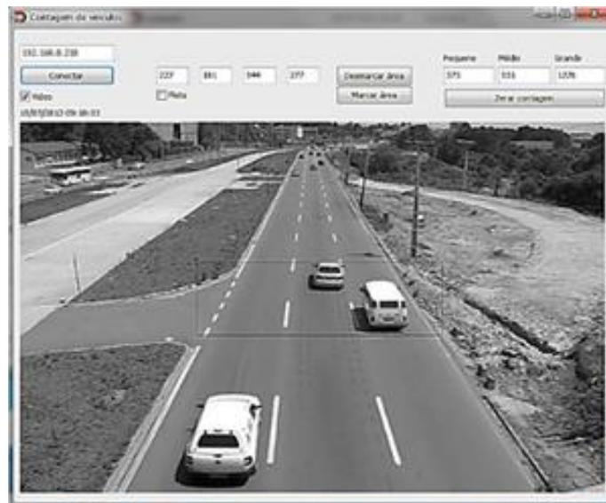
Figura 6 - Interface do Contador de Veículos da ITSCAM 400
