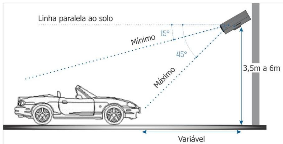
Figura 17 - Vista Lateral da instalação
