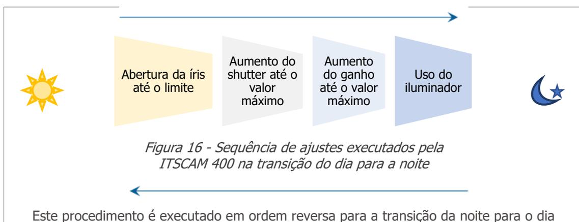
Figura 16 - Sequência de ajustes executados pela ITSCAM 400 na transição do dia para a noite
