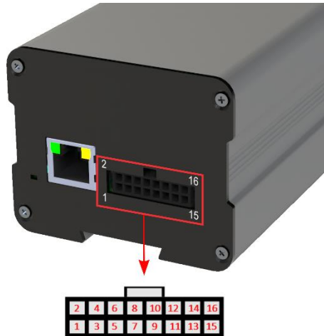
Figura 11 - Terminales del conector de alimentación y señal ITSCAM 400 (Microfit)
