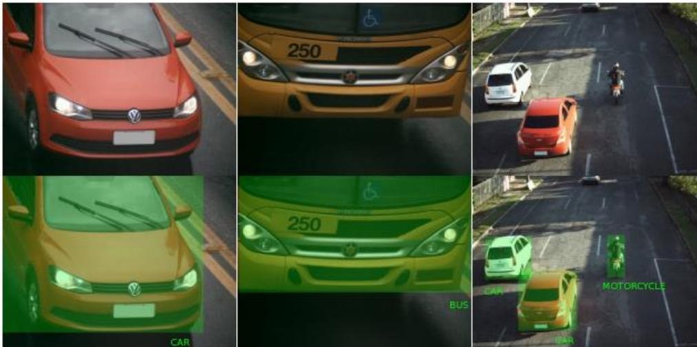
Figura 1 - Exemplos de aplicação do Classifier: **Cima:** imagens a serem processadas pelo Classifier; **Baixo:** imagens sobrepostas com informações obtidas pelo Classifier; **Esquerda e centro:** imagens do tipo fechada; **Direita:** imagem do tipo panorâmica
