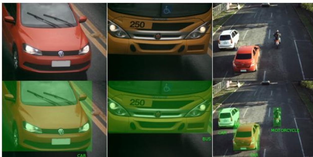
Figura 1 - Ejemplos de aplicación del Clasificador: Arriba: imágenes que serán procesadas por el Clasificador; Bajo: imágenes superpuestas con información obtenida por el Clasificador; Izquierda y centro: imágenes de tipo cerrado; Derecha: imagen panorámica
