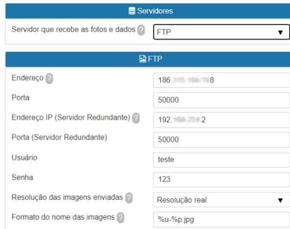
Figura 13 – Campos disponíveis para configuração do servidor FTP
