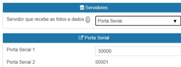
Figura 16 - Campos disponíveis para configuração do servidor Porta Serial
