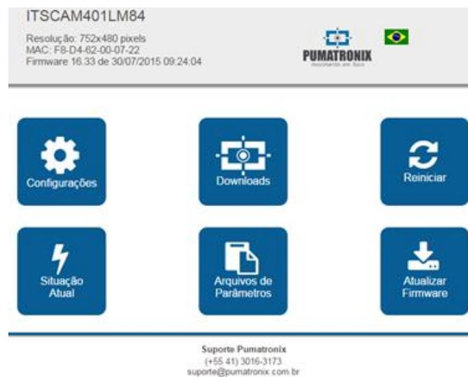
Figura 3 - Tela inicial da Interface das versões de firmware 16.X a 17.X
