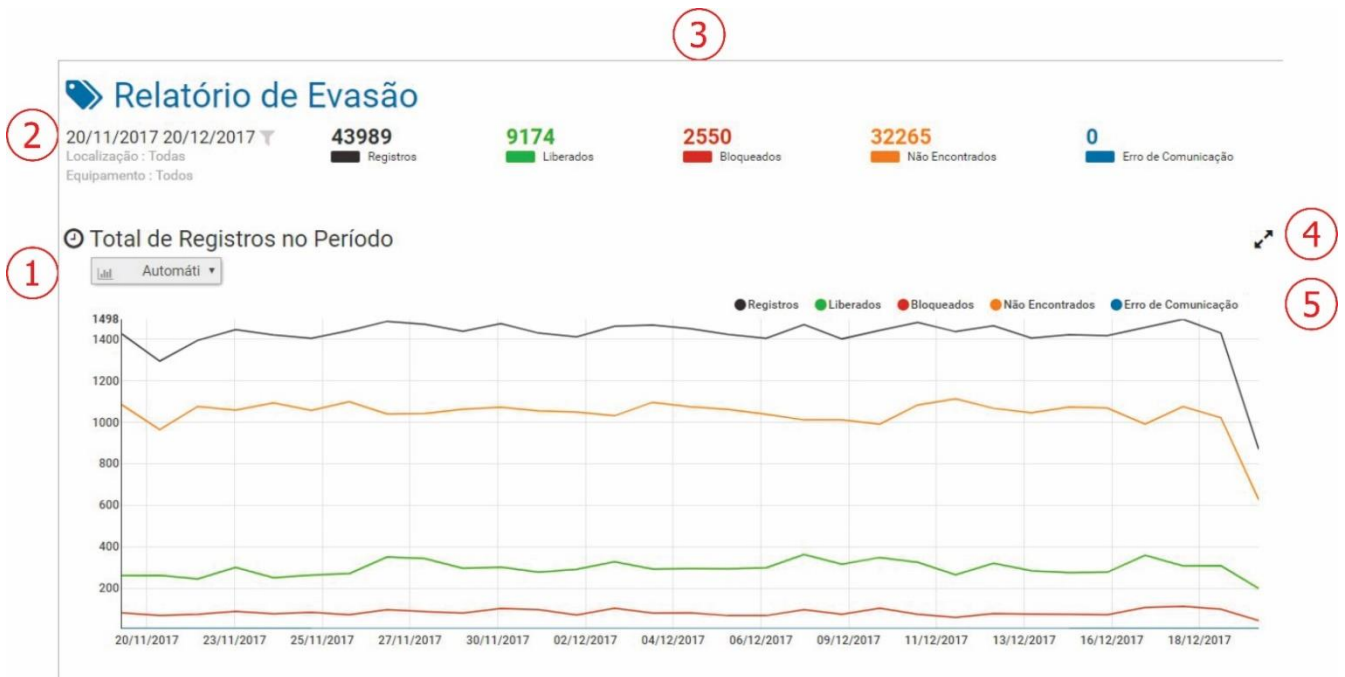
Figura 23 - Tela do Menu Relatórios > Evasão: 1) Tipo de gráfico, 2) Filtro do período dos registros, 3) Quantitativo de registros por status da TAG, 4) Opção de ampliar o tamanho de visualização do gráfico, 5) Legenda e seleção dos dados para exibição no gráfico
