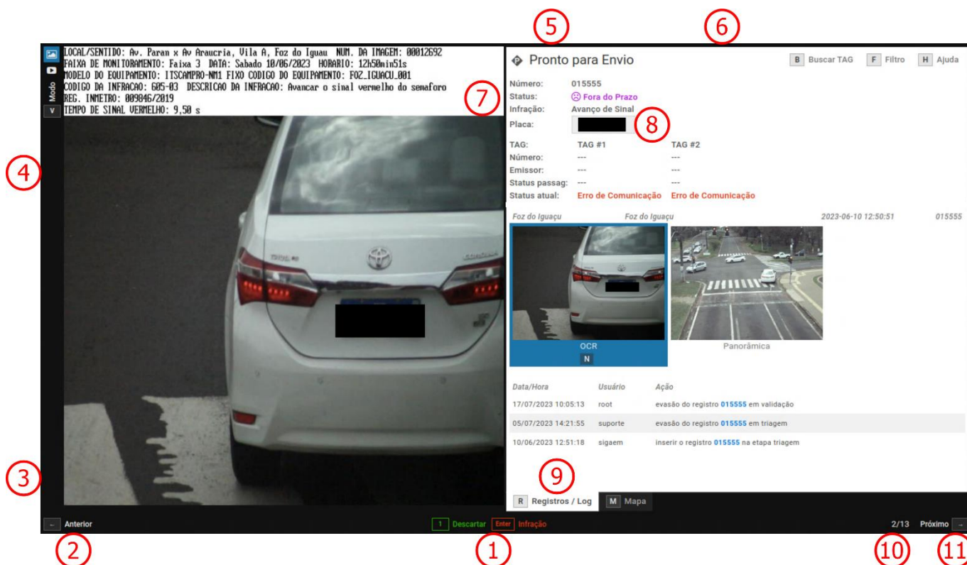
Figura 22 - Tela de uma etapa de Validação Manual: 1) Ação de triagem configurada* para a etapa, 2) Retorna para o registro anterior, 3) Seleção do modo de exibição do vídeo, 4) Visualização das imagens capturadas, 5) Identificação da etapa de triagem, 6) Opções de Busca TAG e Filtro** para pesquisas, 7) Status do registro, 8) Campo para edição da placa registrada, 9) Visualização dos dados do registro, 10) Avançar para o próximo registro
