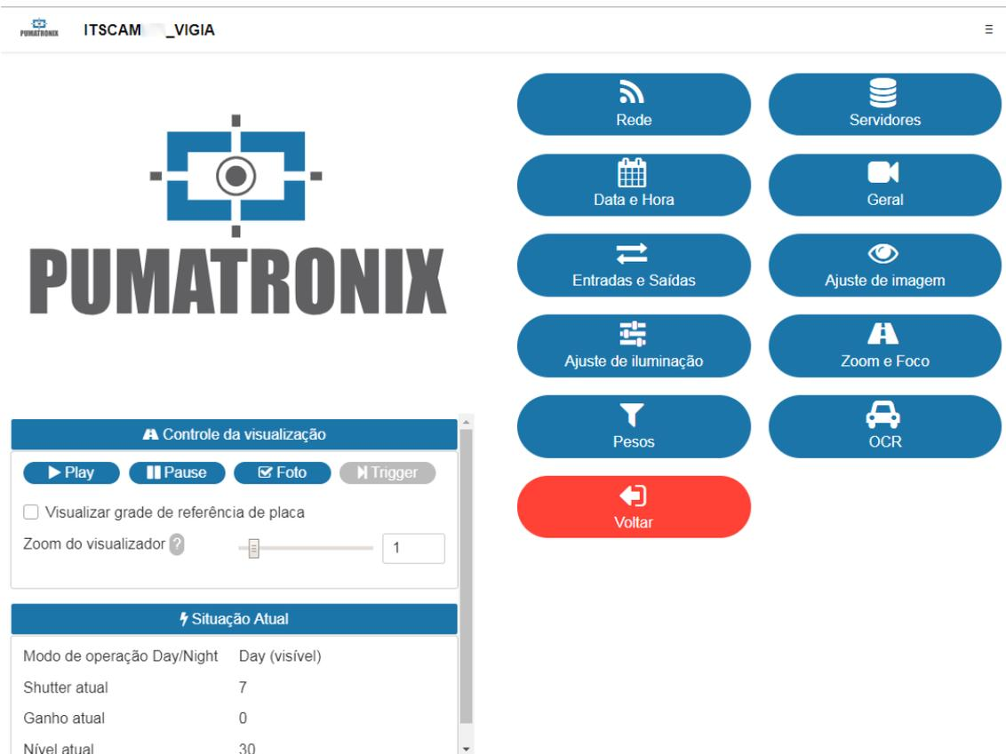
Figura 66 - Tela da interface Web do dispositivo ITSCAM VIGIA+ em Configurações
