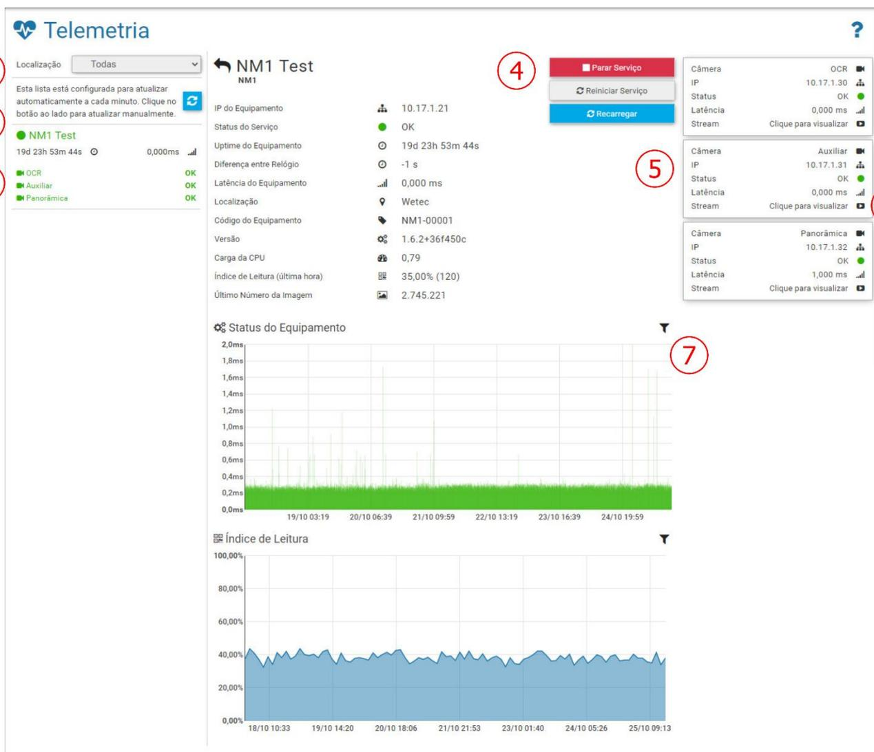
*Figura 11 - Dados de Telemetria dos dispositivos em uma pista: 1) Seleção da Localização do Equipamento, 2) Opção de recarregar e atualizar os dados dos equipamentos, 3) Dados do equipamento e dos respectivos dispositivos, 4) Ações disponíveis para o conjunto de dispositivos da pista, 5) Status de cada dispositivo ITSCAM conectado, 6) Opção de visualização da imagem de um dispositivo, 7) Filtro do período exibido no gráfico*
