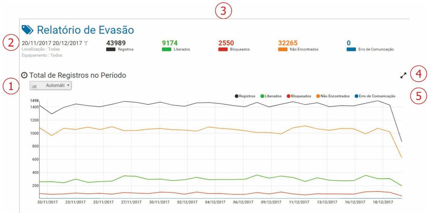
Figura 24 - Pantalla de Menú Informes> Evasión: 1) Tipo de gráfico, 2) Filtro del período de los registros, 3) Cuantitativo de los registros por estatus de la TAG, 4) Opción de ampliar el tamaño de visualización del gráfico, 5) Subtítulo y selección de los datos para exhibición en el gráfico
