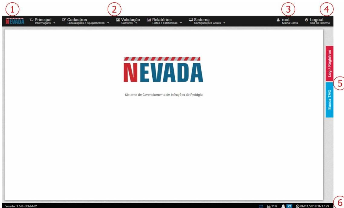
Figura 1 - Pantalla Inicial: 1) Acceso a la página inicial, 2) Barra de Menús, 3) Datos de la Cuenta del usuario conectado, 4) Función Desconectar, 5) Pestañas laterales, 6) Barra de Status
