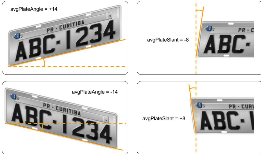
Figura 10 - Como calcular os valores de avgPlateAngle e avgPlateSlant
