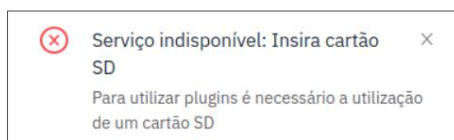
Figura 13 – Mensagem de erro exibida na ausência do cartão SD
