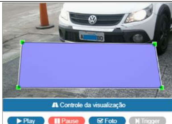
Figura 26 - Visualização da Imagem com uma região de interesse (ROI) configurada para o OCR, que busca por placas na parte interna do retângulo
