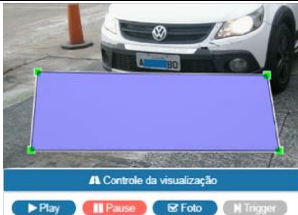
Figura 26 - Visualização da Imagem com uma região de interesse (ROI) configurada para o OCR, que busca por placas na parte interna do retângulo
