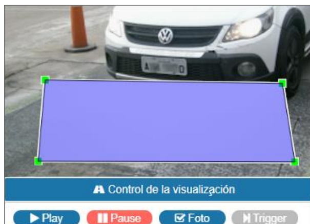
Figura 26 - Visualización de la Imagen con una región de interés (ROI) configurada para el OCR, que busca por placas en la parte interna del rectángulo
