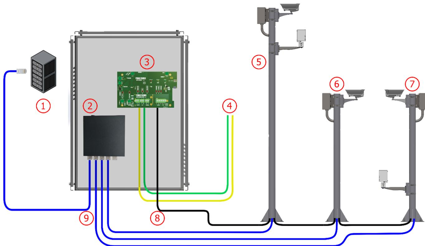
Figura 14 - Diagrama de Instalação do NEVADA em uma pista: 1) Unidade de Processamento da pista, 2) Switch, 3) Placa Supervisora no Quadro de Comando, 4) Sinais de um sensor da Pista, 5) Poste Imagem Panorâmica, 6) Poste Imagem Traseira, 7) Poste Imagem Frontal, 8) Cabo manga 8x22AWG blindado, 9) Cabo CAT-5E Furukawa Externo
