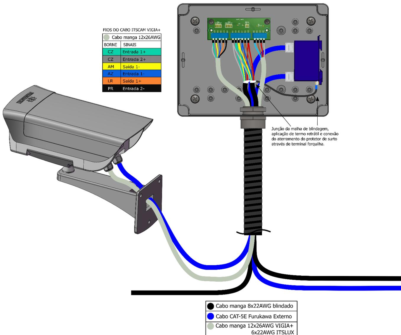
Figura 17 - Ligação da ITSCAM VIGIA+ no Poste Traseiro ou Panorâmico (sem iluminador)
