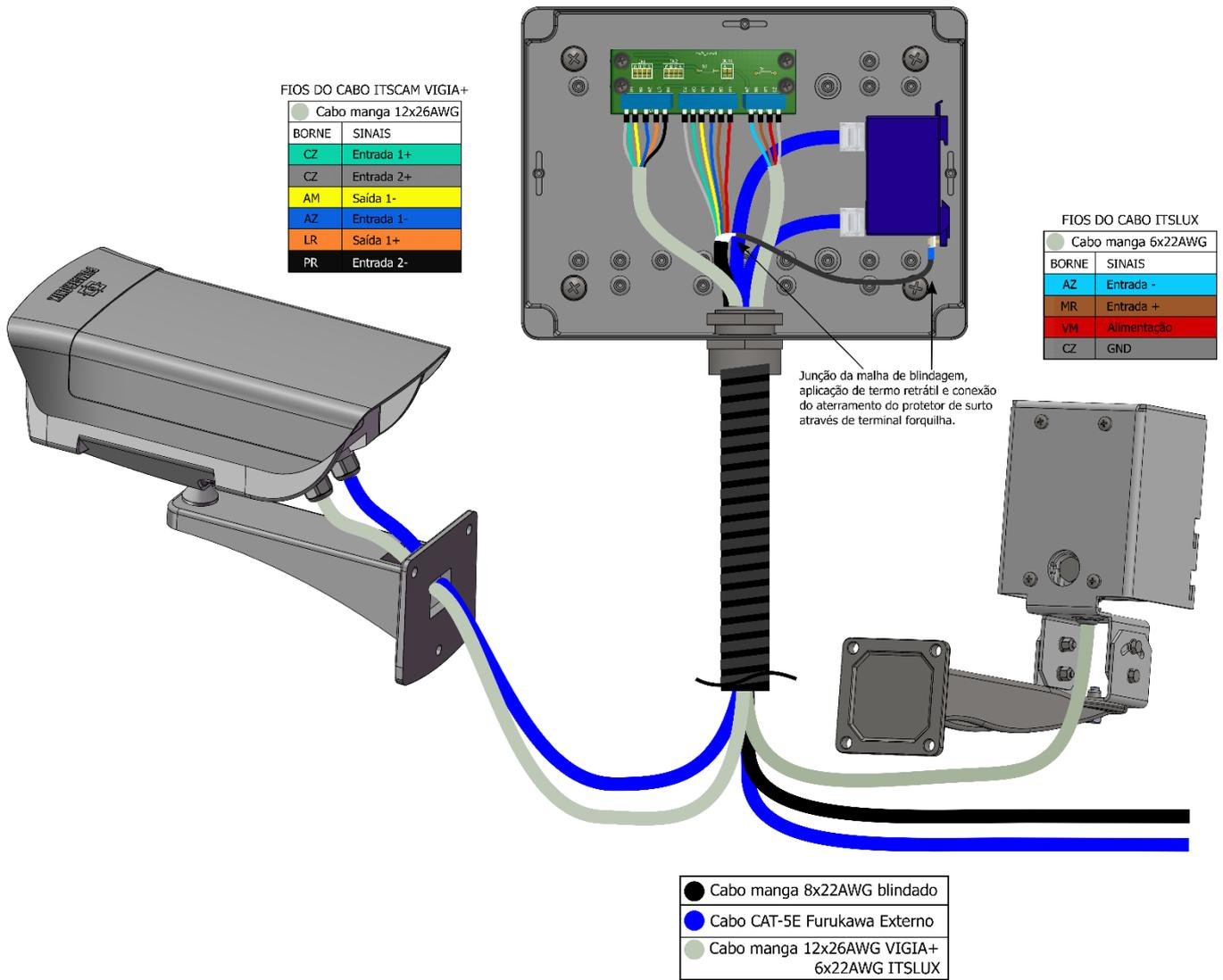
*Figura 16 - Ligação da ITSCAM VIGIA+ e ITSLUX no Poste Frontal*
