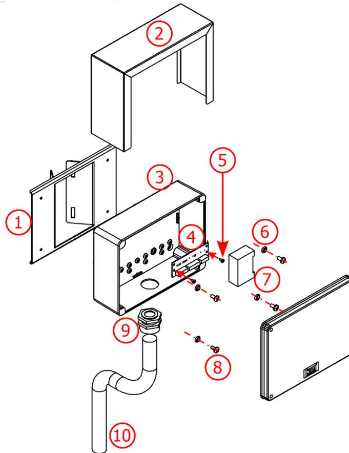
Figura 6 - Componentes da Caixa de Passagem
