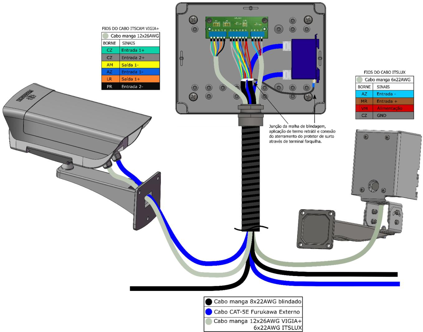
Figura 15 - Ligações da ITSCAM VIGIA+ e ITSLUX no Poste Panorâmico (com iluminador)
