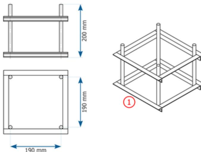
Figura 4 - Dimensões do Chumbador 190mm (1)
