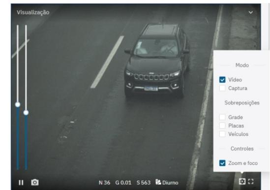
**46.** Utilice la función *Autofocus* cuando el modelo ITSCAM 600 tenga lentes motorizados o ajuste el *Zoom* y el *Enfoque* accediendo al menú *Imagen > Perfiles* en la pestaña *Lente*, hasta que los caracteres se aclaren en la imagen mostrada.
