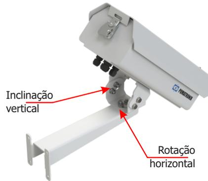
**29.** Incline o equipamento no suporte até o melhor ajuste do enquadramento, considerando o ângulo limite máximo de **45°** para inclinação vertical. Ângulos maiores de inclinação vertical geram deformações significativas nas imagens.
