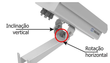
29. Incline o equipamento no suporte até o melhor ajuste do enquadramento, considerando o ângulo limite máximo de 45° para inclinação vertical. Ângulos maiores de inclinação vertical geram deformações significativas nas imagens.
