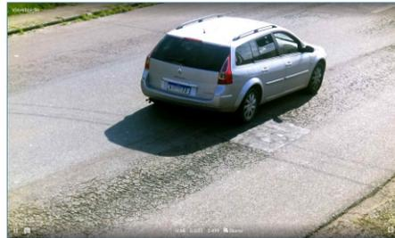
35. Considere ajustar a *Perspectiva* através dos ângulos de inclinação e rotação da imagem, acessando *Equipamento > Reconhecimento* aba *Jidosha*, caso a inclinação do equipamento com o suporte tenha atingido o limite de 45° (passo 30).
