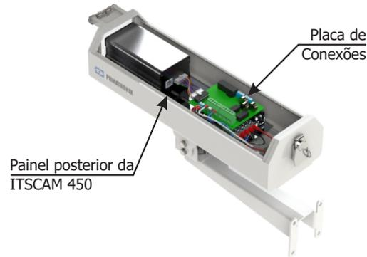
4. Utilize o conector Ethernet disponível no painel posterior do dispositivo ITSCAM 450 para conectar a ITSCAM FF 450 à rede local:
