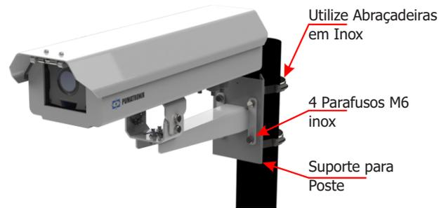
24. Posicione a ITSCAM FF 450 fixada ao *Suporte para Poste* sobre a via, respeitando os limites mínimos de altura especificados para o local e as distâncias mínimas e máximas indicadas em *POSICIONAMENTO DA ITSCAM FF 450 NA VIA*.
