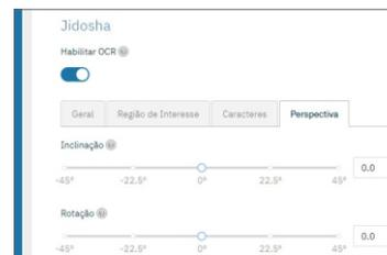
36. Ajuste as definições do processamento do OCR pelo dispositivo, acessando no menu *Equipamento > Reconhecimento* aba *Jidosha*, a opção *Habilitar OCR*.
