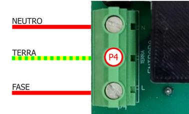
\* Cores de acordo com o indicado na NBR 5410 e usuário pode disponibilizar na instalação 110 VAC ou 220 VAC.
