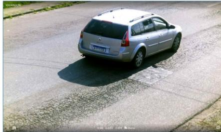
35. Considera ajustar la perspectiva mediante los ángulos de inclinación y rotación de la imagen, accediendo a Equipo > Reconocimiento en la pestaña Jidosha, en caso de que la inclinación haya alcanzado el límite de 45° (paso 30).
