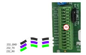
RS-232 CONNECTION ON THE MODEL ITSCAM FF 450 (CP6I7)
