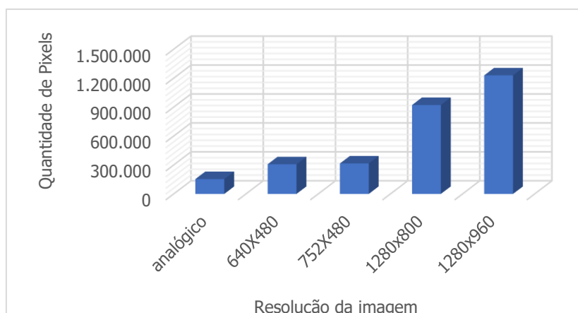
Figura 3 - Comparação entre o número real de pixels das imagens analógicas e digitais
