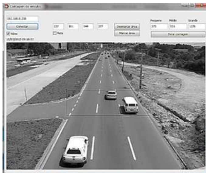
Figura 5 - Interfaz del Contador de vehículos de ITSCAM VIGIA+
