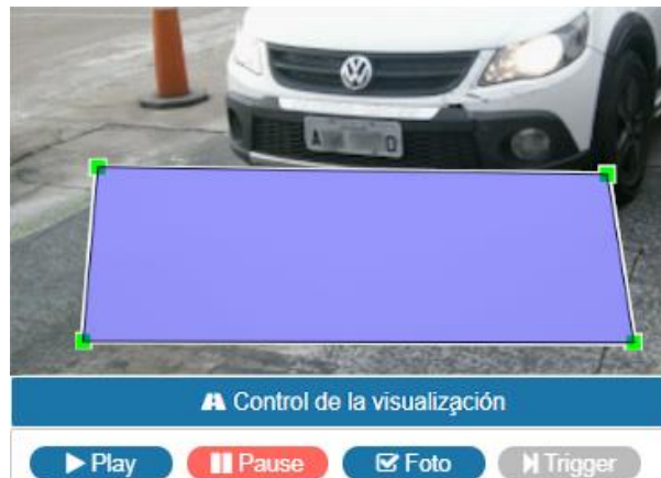
Figura 26 - Visualización de la Imagen con una región de interés (ROI) configurada para el OCR, que busca por placas en la parte interna del rectángulo
