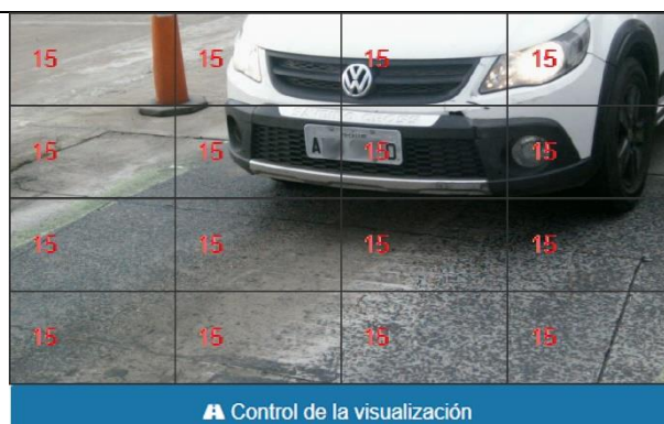
Figura 28 - Coeficientes de importancia (Pesos) de las regiones demarcadas en la imagen
