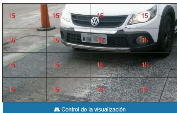
Figura 22 - Coeficientes de importancia (Pesos) de las regiones demarcadas en la imagen, al acceder a Configuraciones > Pesos
